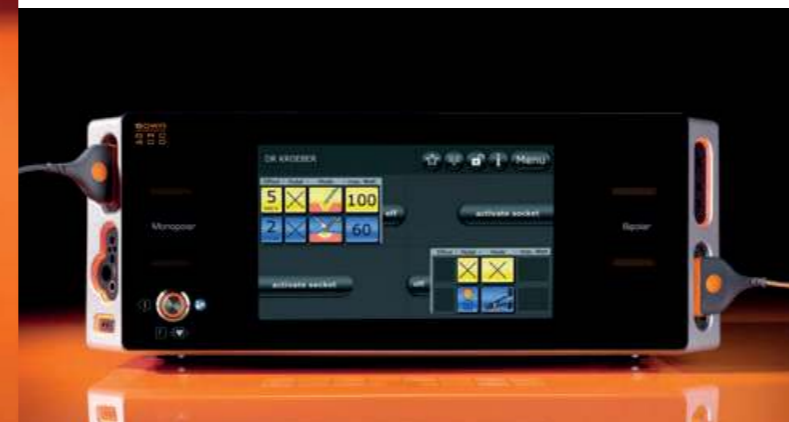
Claridad: cada enchufe conectado (en esta foto, el superior izquierdo y el inferior derecho) está claramente asignado a un cuadrante de la pantalla
