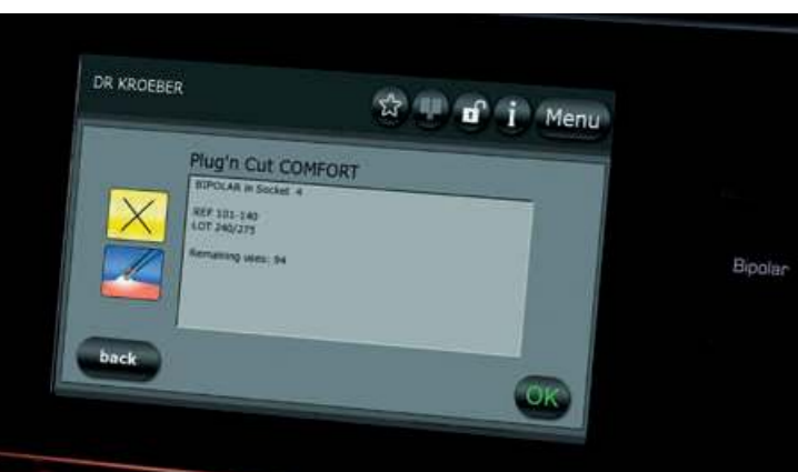
COMFORT Plug'n Cut: El SISTEMA COMFORT reconoce automáticamente el instrumento COMFORT, indica cuántas veces aún puede usarse y selecciona los parámetros correctos para el procedimiento
