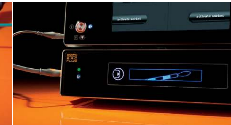
La activación de los modos de argón también se visualiza en el ARC PLUS
