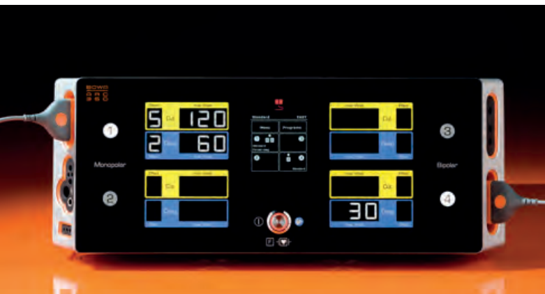
Claridad: cada enchufe conectado (en esta foto, el superior izquierdo y el inferior derecho) está claramente asignado a un cuadrante de la pantalla
