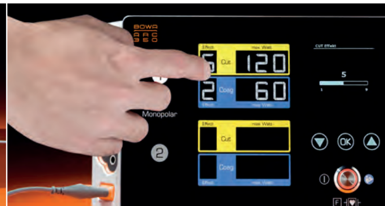
Fácil de usar: toque el campo correspondiente para activar el menú de entrada en el centro del ARC 350 para ajustar efectos o valores de potencia
