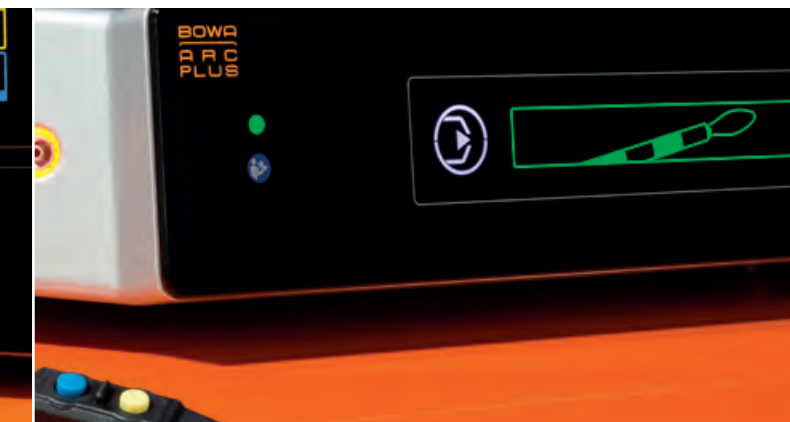
La pantalla verde indica el prelavado de los instrumentos conectados con argón
